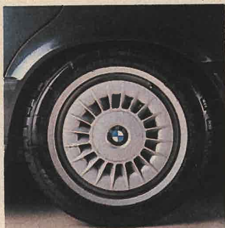
BMW M 5: Alu-Rad mit Turbinenkühlung
