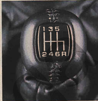
Opel Lotus Omega: Getrag-Getriebe mit sechs Gängen
