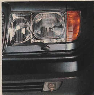
Mercedes 500 E: Leuchteneinheit mit Fernscheinwerfer
