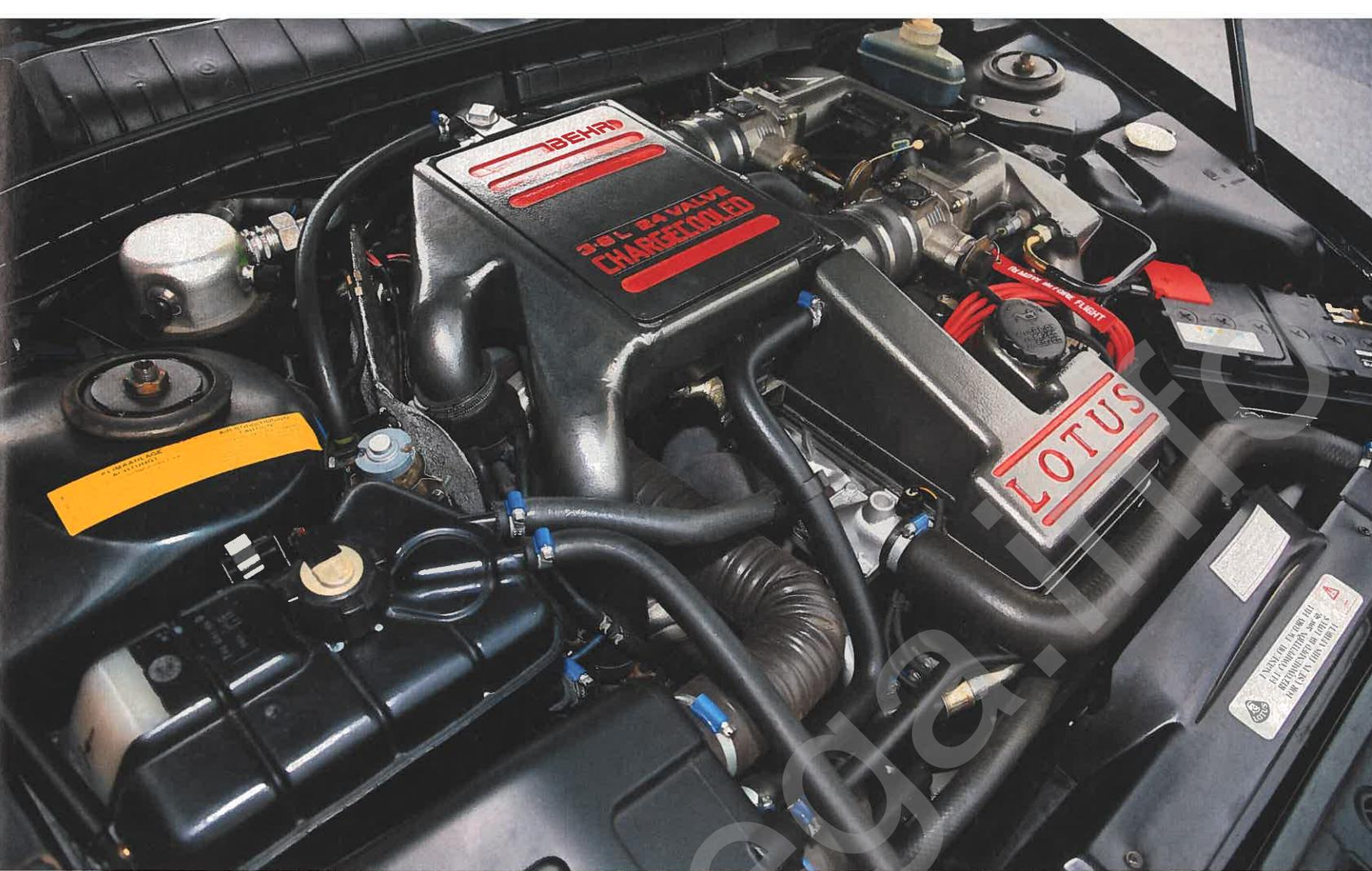
Dem von Lotus überarbeiteten Opel-Sechszylinder verhelfen zwei Turbolader zu immerhin 377 PS
